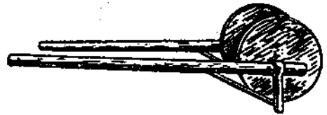
Hình 2-8. Giá đỡ bằng gỗ dùng để rải hoặc cuốn cuộn dây
