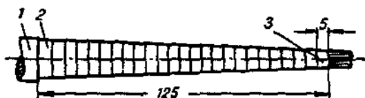
Hình 4-41. Bóc tách theo cấp các lớp cách điện giấy của cáp 35 kV.
